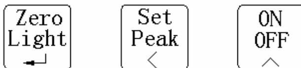
1. [ON/OFF/∧] 键： 长按此键开机。在测力/称重界面按此键，显示“OFF”，再按此键，关闭电源。在显示“OFF”时按 [Set/Peak/<] 键，退出。在设置状态按此键，进行个位加一操作。
