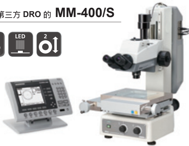
使用 PS 2×2B 载物台、三目头、ND 1200 QUADRA-CHEK 的配置
